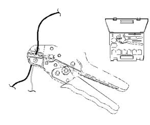
D) Isolare la crimpatura tramite nastro isolante nero
